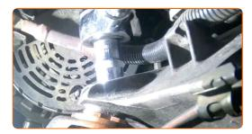
Conecte a mangueira de vácuo ao apoio do motor.
