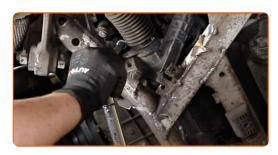
Aperte o fixador superior do apoio do motor. Use uma chave soquete nº 16. Use uma chave de torque. Aperte-o para o torque de 51 Nm.
