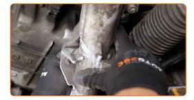
Trate os fixadores do apoio do motor. Use massa de cobre.
