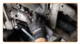
Desaperte o fixador inferior do apoio do motor. Use uma chave soquete nº 16. Use uma chave de catraca.
