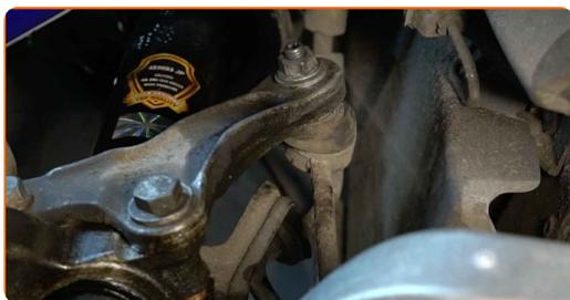
**7** Desaparafuse o fixador que conecta a bieleta da barra estabilizadora à barra estabilizadora. Use uma chave soquete nº 16. Use uma chave de catraca.
