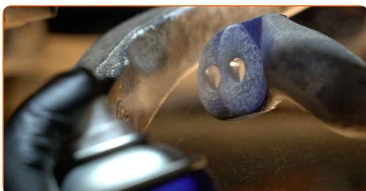
**11** Instale o terminal do estabilizador transversal.
