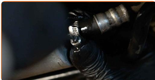
**17** Limpe o suporte de montagem do filtro de combustível. Use o spray de limpeza universal.
