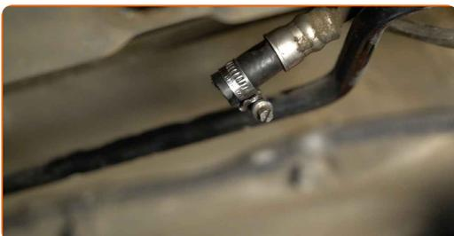
**8** Desaperte os parafusos de fixação do suporte do filtro de combustível. Use Torx T40. Use uma chave de catraca.
