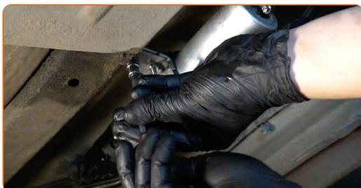
**16** Aperte o grampo de fixação do tubo do filtro de combustível. Use uma chave de fenda plana.
