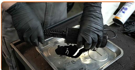
**14** Remova o anel O-ring de vedação da tampa do filtro de óleo. Use uma chave de fenda plana.
