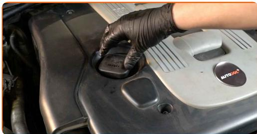
**31** Ligue o motor por alguns minutos. Após a luz de advertência da pressão do óleo se apagar, desligue o motor.
