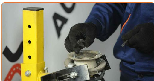
36 Trate a haste da coluna do amortecedor. Use uma escova metálica. Use spray WD-40.
