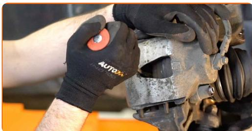
**13** Limpe os elementos de fixação da pinça de travão. Use uma escova metálica. Use spray WD-40.
