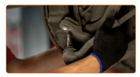
Desaperte a fixação do sensor ABS da manga de eixo. Use HEX n.º H5 Use uma chave de catraca.
