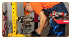
Remova a tampa do apoio da coluna de suspensão. Use uma chave de fenda plana.
