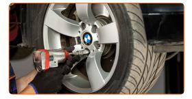
Baixar o carro e trabalhar em ordem transversal, apertar os parafusos das rodas. Use o soquete de impacto para roda #17. Use uma chave de torque. Aperte-o para o torque de 120 Nm.
