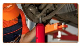
Instale o apoio no suporte do amortecedor.
