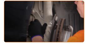
Limpe os elementos de fixação que conectam o braço de controlo à subestrutura. Use uma escova metálica. Use spray WD-40.
