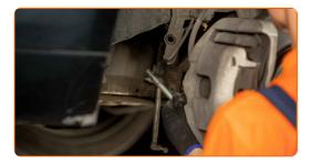
Remova o apoio do suporte do amortecedor.
