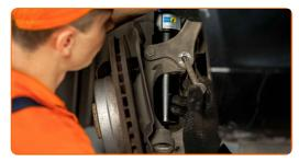
Aperte o fixador do suporte da biela do estabilizador. Use uma chave soquete nº 16. Use uma chave de catraca. Use uma chave de torque. Aperte-o para o torque de 65 Nm.
