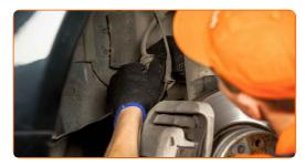
Separe o suporte da cablagem do ABS. Use uma chave de fenda plana.
