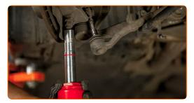
Aperte o fixador traseiro do braço da suspensão. Use uma chave combinada nº 18. Use uma chave soquete nº 18. Use uma chave de torque. Aperte-o para o torque de 100 Nm.+90°
