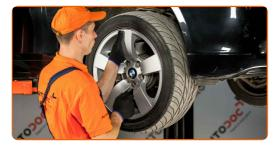
Limpe o elemento de fixação que conecta o terminal de direção à manga de eixo. Use uma escova metálica. Use spray WD-40.
