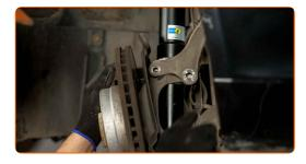
58 Instale os parafusos de fixação.
