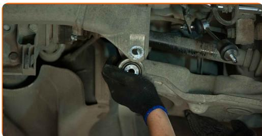
**41** Instale o terminal do estabilizador transversal.
