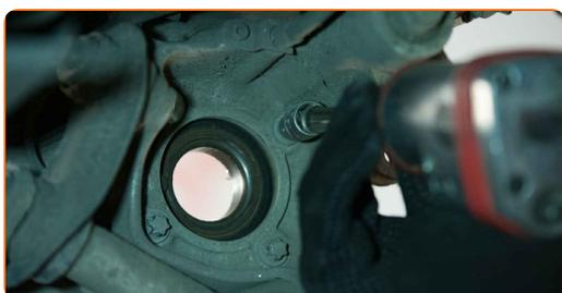
**32** Retire os parafusos de fixação. Use um saca-pino. Use um martelo.
