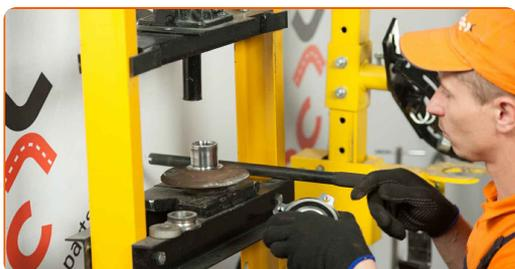
**35** Instale o novo cubo da roda com um rolamento.
