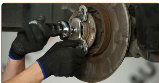
**16** Remova o anel interior do cubo de rolamento para fora do cubo da roda. Use um martelo de borracha.
