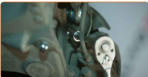
**11** Retire a pinça de travão em conjunto com o seu suporte. Use uma chave de fenda plana.
