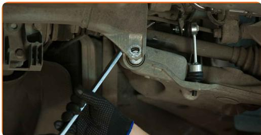
**29** Desaperte os parafusos de fixação do eixo de transmissão da caixa de velocidades. Use uma chave soquete nº E12. Use uma chave de catraca.
