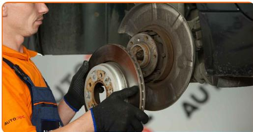
**15** Usando um extrator, remova o cubo da roda do rolamento. Use o martelo deslizante para extração do cubo da roda.
