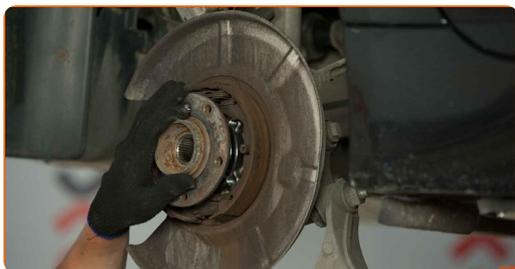
**36** Instale os parafusos de fixação.
