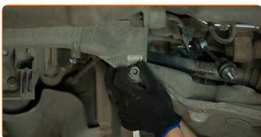
**45** Aperte o braço de fixação traseiro. Use uma chave combinada nº 18. Use uma chave soquete nº 18. Use uma chave de catraca.
