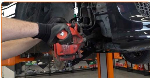
8 Desligue o soquete elétrico do sensor de ABS. Desconecte o sensor do indicador de desgaste das pastilhas de travão. Retire o conector do sensor ABS. Retire o conector do sensor de desgaste da pastilha de travão.
