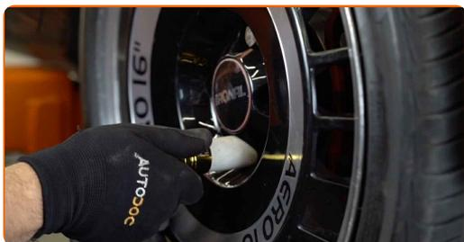
29 Baixe o carro e trabalhar em ordem transversal, apertar os parafusos das rodas. Use uma chave de torque. Aperte-o para o torque de 110 Nm.
