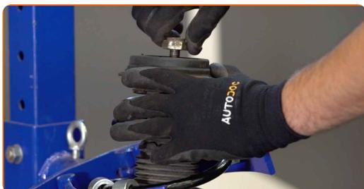
34 Aperte a porca do suporte do amortecedor da haste do pistão. Use uma chave combinada nº 27. Use HEX n.º H7 Use uma chave de torque. Aperte-o para o torque de 60 Nm.
