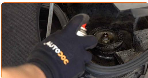
6 Desapertar a fixação superior de montagem do suporte do amortecedor. Use uma chave combinada nº 19. Use HEX n.º H7. Use uma chave de catraca.
