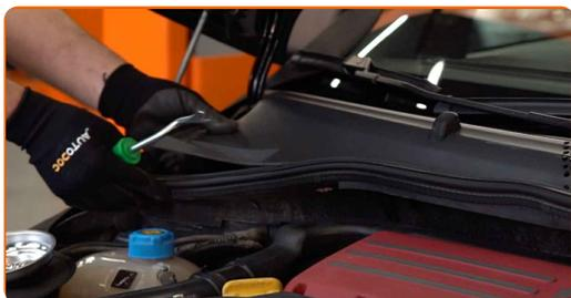
5 Limpe os fixadores da montagem superior do suporte do amortecedor. Use spray WD-40.
