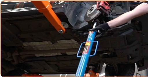
16 Desaparafuse o elemento de fixação inferior que liga a coluna de suspensão às mangas de eixo. Use uma chave de estrela #17. Use uma chave soquete nº 15. Use uma chave de catraca.
