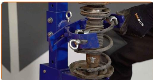
23 Limpe a haste do amortecedor. Use uma escova metálica. Use spray WD-40.
