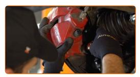
Aperte a braçadeira da pinça do travão. Use uma chave soquete nº 21. Use uma chave de torque. Aperte-o para o torque de 190 Nm.
