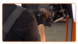
Limpe o cubo. Use uma escova metálica. Use spray WD-40.
