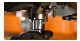
Desaperte a porca do eixo do cubo da roda. Use XZN #12. Use uma chave de catraca. Use uma chave de tarraxa.
