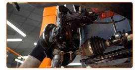
Aperte o cubo. Use XZN #12. Use uma chave de torque. Aperte-o para o torque de 70 Nm.+90°
