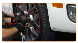
Afrouxe o parafuso do cubo de roda. Use uma chave de caixa de 12 pontos #24. Use uma chave de tarraxa.
