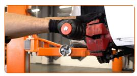
Desaperte a fixação da braçadeira da pinça. Use uma chave soquete nº 21. Use uma chave de catraca. Use uma chave de tarraxa.
