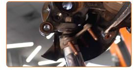
Aperte a porca de fixação da articulação esférica. Use uma chave soquete nº 15. Use uma chave de torque. Aperte-o para o torque de 60 Nm.
