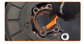
Instale o novo cubo da roda com um rolamento.
