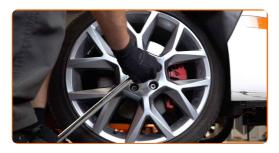
Desaperte os parafusos da roda.
