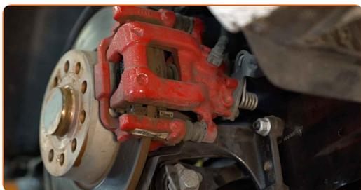
8 Desaparafuse a fixação de pinça de travão. Use uma chave combinada nº 13. Use uma chave combinada nº 19.
