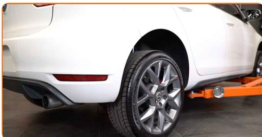
5 Desaperte os parafusos da roda.
