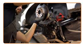
Retire a tampa de proteção de rolamento de cubo. Utilize um pé-de-cabra. Use um martelo de borracha.
