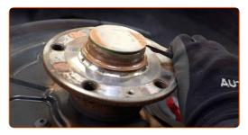
Desaperte a porca do eixo do cubo da roda. Use XZN #18. Use uma chave de tarraxa.
