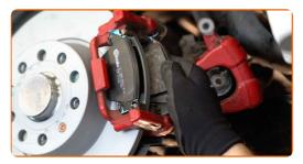
Instale a pinça do travão e fixe-o. Use uma chave combinada nº 13. Use uma chave combinada nº 19. Use uma chave soquete nº 13. Use uma chave de torque. Aperte-o para o torque de 35 Nm.
