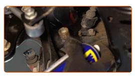
Desaperte a fixação da braçadeira da pinça. Use XZN #12. Use uma chave de tarraxa. Use uma chave de catraca.
