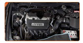
Despeje o óleo no motor através do gargalo de enchimento de óleo. Quantidade necessária de óleo: 4.7 l.
