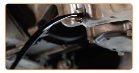
Substituição: óleo do motor e filtro – Honda Accord VIII CU. Conselho:
