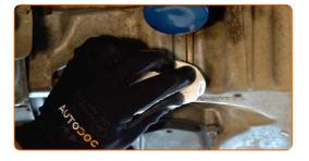
Aparafuse o novo bujão de drenagem e aperte-o. Use uma chave soquete nº 17. Use uma chave de torque. Aperte-o para o torque de 38 Nm.
