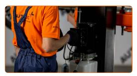
Desaparafuse o fixador que conecta a linha de combustível ao alojamento do filtro de combustível. Use uma chave combinada nº 19. Use uma chave combinada nº 22.
