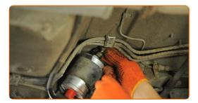
Aparafuse o elemento de fixação que liga a linha de combustível ao alojamento do filtro de combustível. Use uma chave combinada nº 17. Use uma chave combinada nº 22.
