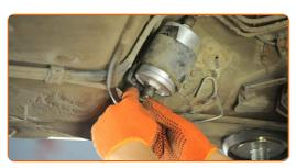
Aparafuse o elemento de fixação que liga a linha de combustível ao alojamento do filtro de combustível. Use uma chave combinada nº 19. Use uma chave combinada nº 22.
