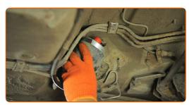
Aperte os parafusos de fixação do suporte do filtro de combustível. Use uma chave soquete nº 10. Use uma chave de catraca.
