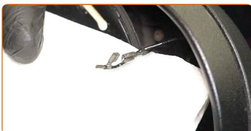
6 Solte o clipe de retenção do vidro do espelho. Use uma chave de fenda plana.
