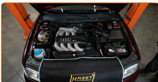
**3** Desaperte os parafusos de fixação da tampa do filtro de ar (4 peças). Use a chave Phillips.
