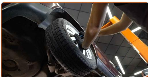
**40** Baixar o carro e trabalhar em ordem transversal, apertar os parafusos das rodas. Use uma chave de torque. Aperte-o para o torque de 120 Nm.
