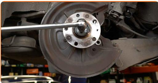
**19** Remova o parafuso de fixação.
