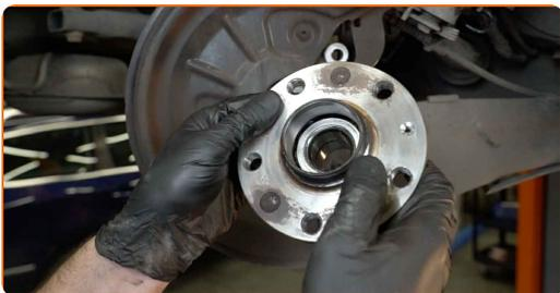
**21** Limpe o local de montagem do rolamento de cubo. Use o spray de limpeza universal.
