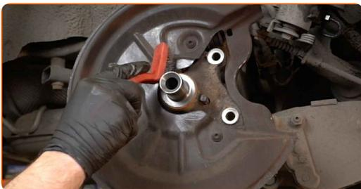
**22** Instale o novo cubo da roda com um rolamento.
