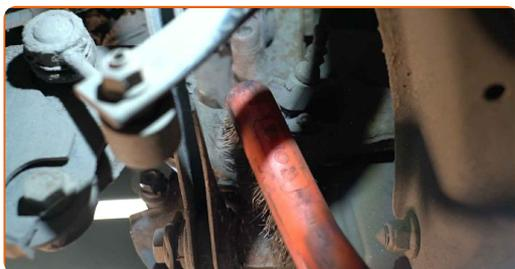
**12** Desaperte a fixação da braçadeira da pinça. Use XZN #14. Use uma chave de tarraxa. Use uma chave de catraca.
