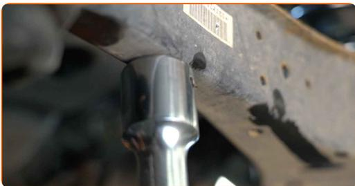
**19** Limpe os locais de montagem e a rosca do braço da suspensão. Use uma escova metálica. Use spray WD-40.
