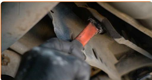
**20** Instale o parafuso de fixação.
