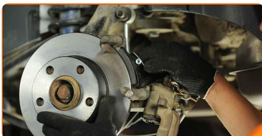
**Substituição: pastilhas de travão – Audi A4 B5 Avant. Conselho da AUTODOC:**
