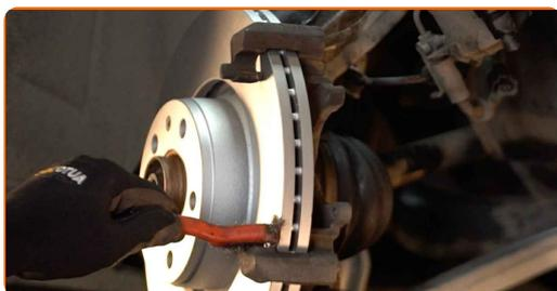
**Substituição: pastilhas de travão – Audi A4 B5 Avant. Conselho:**
