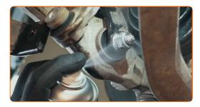
Desaparafuse o elemento de fixação inferior que liga a coluna de suspensão às mangas de eixo. Use uma chave combinada nº 18. Use uma chave soquete nº 18. Use uma chave de catraca.
