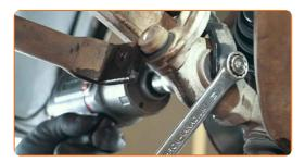
Remova o parafuso de fixação.
