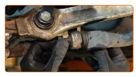
Aperte o fixador da bieleta da barra estabilizadora. Use uma chave combinada nº 16. Use uma chave soquete nº 16. Use uma chave de catraca.
