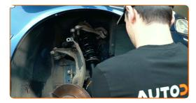
Prenda os fixadores superiores do amortecedor. Use uma chave soquete nº 16. Use uma chave de catraca. Não o aperte.
