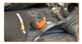
Solte os fixadores superiores do dispositivo amortecedor. Use uma chave soquete nº 16. Use uma chave de catraca.
