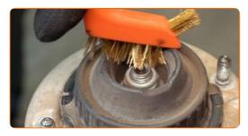
Desaparafuse a porca do eixo do pistão da suspensão. Use uma chave soquete nº 18. Use HEX n.º H6. Use uma chave de catraca.
