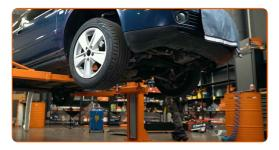
Desaperte os parafusos da roda.
