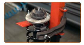
Trate a haste da coluna do amortecedor. Use massa de cobre.
