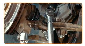
Aperte o fixador que liga o braço de controlo ao subchassis. Use uma chave combinada nº 18. Use uma chave de torque. Aperte-o para o torque de 80 Nm.+90°
