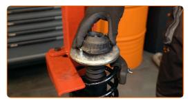
Aperte a porca do suporte do amortecedor da haste do pistão. Use HEX n.º H6. Use uma chave soquete nº 18. Use uma chave de torque. Aperte-o para o torque de 50 Nm.
