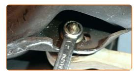
Remova o parafuso de fixação.
