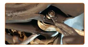
68 Instale o parafuso de fixação.
