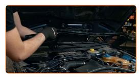
Limpe os fixadores da montagem superior do suporte do amortecedor. Use uma escova metálica. Use spray WD-40.
