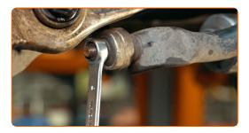
Aperte o fixador que conecta a bieleta da barra estabilizadora à barra estabilizadora. Use uma chave combinada nº 16. Use uma chave soquete nº 16. Use uma chave de torque. Aperte-o para o torque de 40 Nm.+90°
