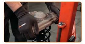
Aperte a fixação superior da montagem do suporte do amortecedor. Use uma chave soquete nº 13. Use uma chave de torque. Aperte-o para o torque de 20 Nm.
