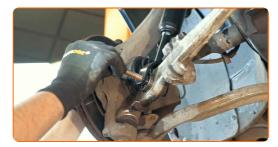
Aparafuse o elemento de fixação inferior do amortecedor. Use uma chave combinada nº 18. Use uma chave soquete nº 18. Use uma chave de catraca.
