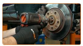
Trate os fixadores da manga de eixo. Trate os fixadores do amortecedor. Trate todas as juntas de conexão do estabilizador. Trate todas as juntas do braço. Use massa de cobre.
