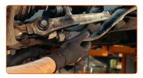
75 Instale o parafuso de fixação.
