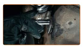
Aperte as braçadeiras de fixação dos tubos do filtro de combustível. Use uma chave de fenda plana.
