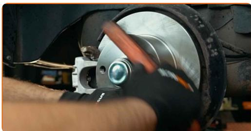
**46** Trate a superfície onde o disco de travão entra em contacto com o aro da roda. Use massa de cobre.
