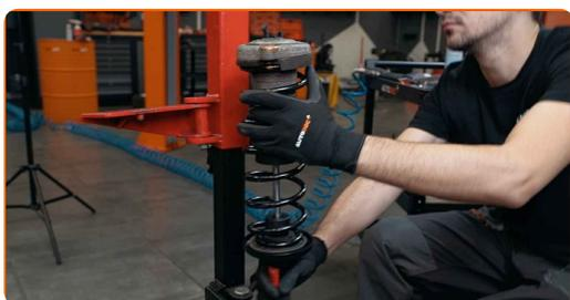
**36** Limpe os assentos de montagem da coluna do amortecedor. Use uma escova metálica. Use spray WD-40.
