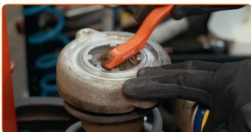
**22** Remova a porca do suporte do pistão. Use uma chave soquete nº 17. Utilize a chave para amortecedor DDNº5,2. Use uma chave de catraca.
