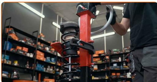
**33** Trate a haste da coluna do amortecedor. Use massa de cobre.
