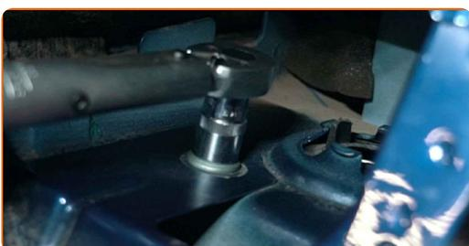
**53** Trate os fixadores do apoio da coluna de suspensão. Use massa de cobre.
