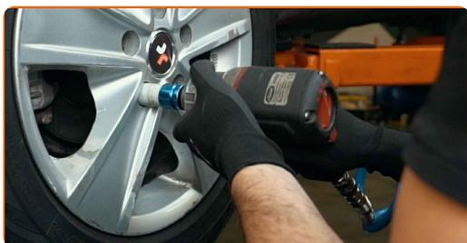
**50** Baixar o carro e trabalhar em ordem transversal, apertar os parafusos das rodas. Use o soquete de impacto para roda #17. Use uma chave de torque. Aperte-o para o torque de 120 Nm.
