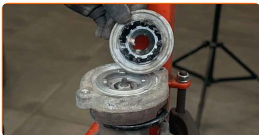
**21** Trate a haste da coluna do amortecedor. Use uma escova metálica. Use spray WD-40.
