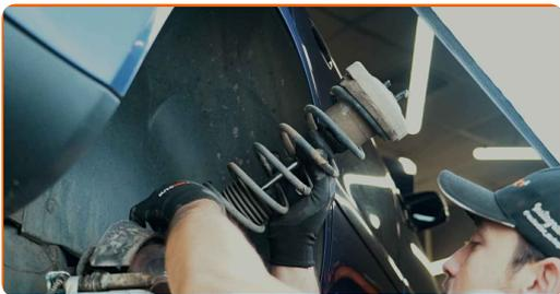
**18** Coloque o suporte do amortecedor sobre a ferramenta de compressão da mola.
