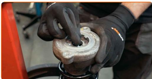
**31** Aperte a porca do suporte do amortecedor da haste do pistão. Use uma chave soquete nº 16. Utilize a chave para amortecedor DDNº5,2. Use uma chave de torque. Aperte-o para o torque de 25 Nm.
