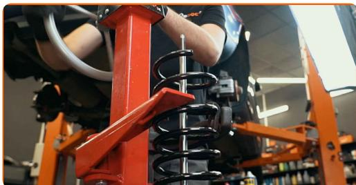
**29** Instale a coifa e o batente de encosto no amortecedor.
