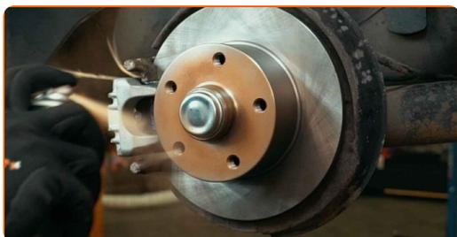
**47** Limpe a superfície do disco de travão. Utilize um produto de limpeza para travões.
