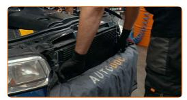
Desaperte o fixador da tampa do motor. Use HEX n.º H5. Use uma chave de catraca.
