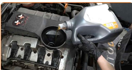
**Substituição: óleo do motor e filtro – Audi A4 B7. AUTODOC recomenda:**
