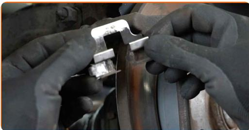
**14** Limpe a braçadeira da pinça de travão de sujidade e poeira. Use uma escova metálica. Use o spray de limpeza universal.
