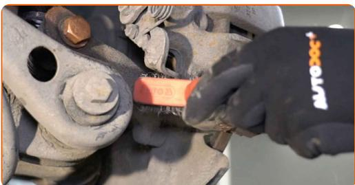
**10** Desaparafuse a fixação de pinça de travão. Use uma chave combinada nº 13. Use uma chave combinada nº 15. Use uma chave soquete nº 13. Use uma chave de catraca.
