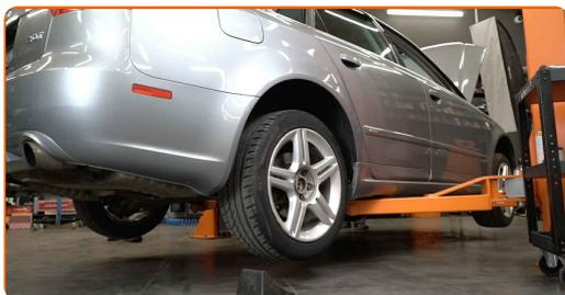
**5** Desaperte os parafusos da roda.
