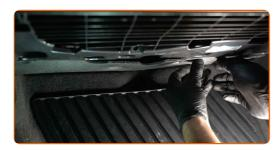
Aparafuse os fixadores do painel de revestimento inferior.
