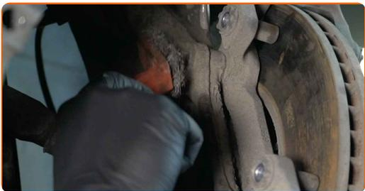
**14** Desaperte a fixação da braçadeira da pinça. Use uma chave soquete nº 21. Use uma chave de tarraxa.
