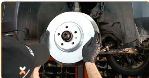
**21** Aperte a fixação do disco de travão. Use Torx T30. Use uma chave de torque. Aperte-o para o torque de 5 Nm.
