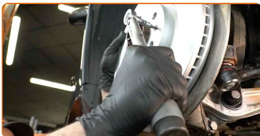
**22** Limpe a braçadeira da pinça de travão de sujidade e poeira. Use uma escova metálica. Utilize um produto de limpeza para travões.
