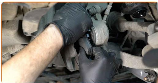
**28** Instale a pinça do travão e fixe-o. Use uma chave soquete nº 13. Use uma chave de torque. Aperte-o para o torque de 30 Nm.
