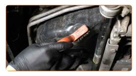
Desaperte o bujão de drenagem. Use Torx T45. Use uma chave de catraca.
