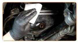
Aparafuse o novo bujão de drenagem e aperte-o. Use Torx T45. Use uma chave de torque. Aperte-o para o torque de 26 Nm.
