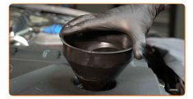
Despeje o óleo no motor através do gargalo de enchimento de óleo. Quantidade necessária de óleo: 4.6 l.
