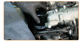
Aparafuse o novo filtro no seu lugar. Use o soquete 76-14F. Use uma chave de torque. Aperte-o para o torque de 18 Nm.
