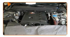
Verifique o nível de óleo 5 minutos após a paragem do funcionamento do motor usando uma vareta e adicione óleo se necessário.
