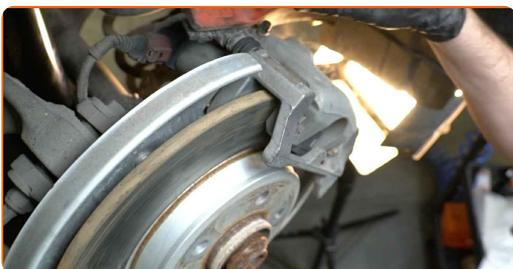
**9** Desaparafuse a fixação de pinça de travão. Use uma chave combinada nº 15. Use uma chave soquete nº 13. Use uma chave de catraca.
