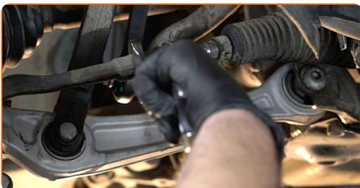
**11** Desconecte o terminal de direção da manga de eixo.
