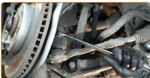
**8** Limpe a contraporca, que liga o tirante à extremidade do tirante. Use uma escova metálica. Use spray WD-40.
