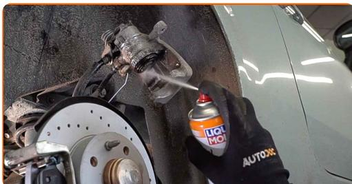
Substituição: pastilhas de travão – ABARTH 500 / 595 / 695 Hatchback (312).
