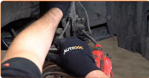
19 Desaperte a fixação do suporte superior do braço do amortecedor.
