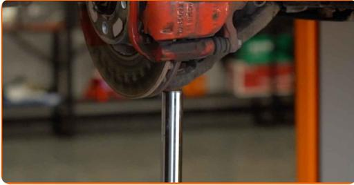
18 Desligar a manga de eixo do suporte do amortecedor.
