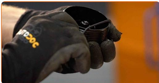
**16** Instale o novo filtro de óleo no assento de montagem na tampa do filtro.
