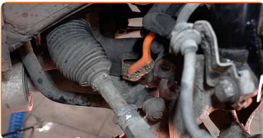
**9** Desaparafuse os fixadores que conectam a bieleta da barra estabilizadora. Use uma chave combinada nº 18. Use HEX n.º H6.
