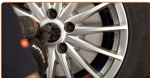
**17** Baixar o carro e trabalhar em ordem transversal, apertar os parafusos das rodas. Use o soquete de impacto para roda #17. Use uma chave de torque. Aperte-o para o torque de 120 Nm.
