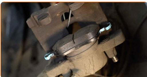
**30** Instale a pinça do travão e fixe-o. Use HEX n.º H7. Use uma chave de torque. Aperte-o para o torque de 30 Nm.
