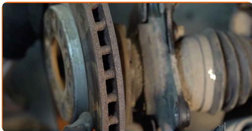
**20** Limpe o cubo. Use uma escova metálica. Trate a superfície de contacto. Use massa de cobre.
