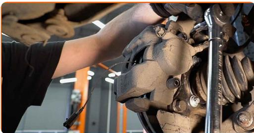
**31** Conecte o sensor do indicador de desgaste das pastilhas de travão.
