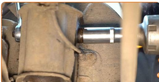
**30** Desaparafuse o fixador que liga o braço da suspensão à manga de eixo. Use uma chave combinada nº 19.
