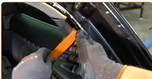
**14** Desaperte os fixadores do painel de acabamento plástico lateral. Use a chave Phillips.
