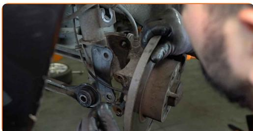
**34** Retire a coluna de suspensão montada. Utilize um pé-de-cabra.
