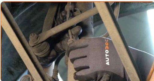
**25** Limpe os elementos de fixação de conexão do estabilizador. Use uma escova metálica. Use spray WD-40.
