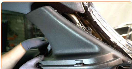
**16** Limpe o fixador superior do suporte do dispositivo amortecedor. Use spray WD-40.
