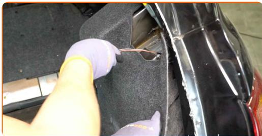
**73** Aparafuse o fixador do forro lateral do porta-malas. Use a chave Phillips.
