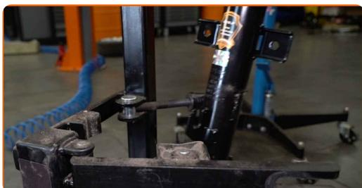
**45** Limpe os assentos de montagem da coluna do amortecedor. Use uma escova metálica. Use spray WD-40.
