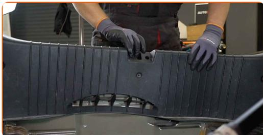
**80** Aparafuse o fixador do painel central de plástico de proteção. Use a chave Phillips.
