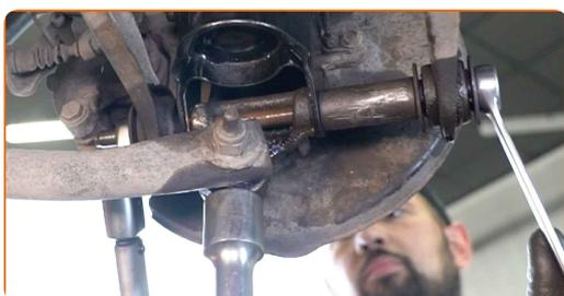
**53** Aperte o elemento fixador, que liga o braço de suspensão à manga de eixo traseira. Use uma chave combinada nº 19. Use uma chave soquete nº 19. Use uma chave de torque. Aperte-o para o torque de 115 Nm.
