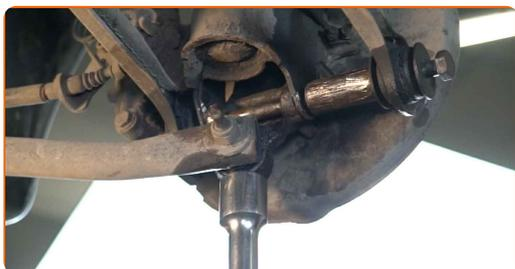
**32** Retire os parafusos de fixação.
