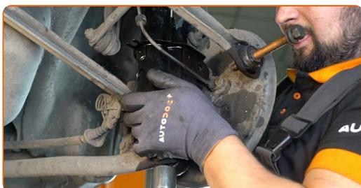
**48** Instale os parafusos de fixação.
