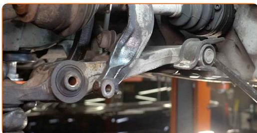
**26** Limpe os locais de montagem e a rosca do braço da suspensão. Use uma escova metálica. Use spray WD-40.
