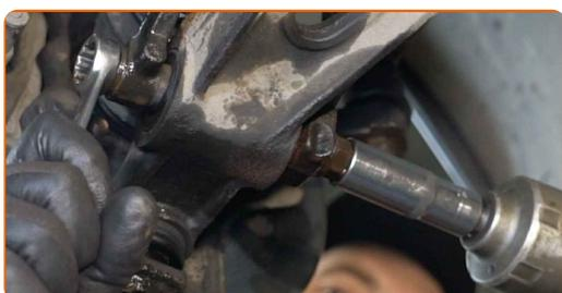
**11** Remova o parafuso de fixação.
