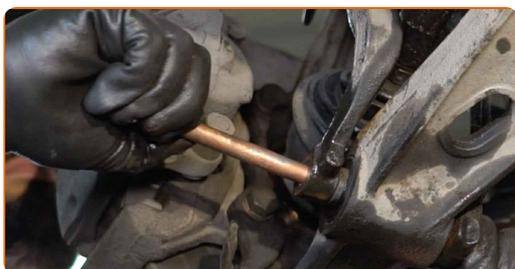
**12** Desaperte a fixação da articulação esférica da manga de eixo. Use uma chave soquete nº 24. Use uma chave de catraca.
