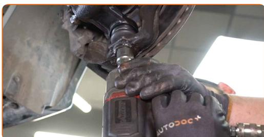
**40** Aperte o fixador que liga a junta esférica à manga de eixo. Use uma chave soquete nº 24. Use uma chave de torque. Aperte-o para o torque de 90 Nm.
