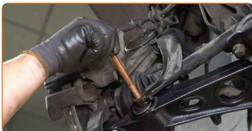
**37** Aparafuse o fixador que liga a forquilha garfo do amortecedor ao braço de suspensão inferior. Use uma chave combinada nº 19. Use uma chave soquete nº 19. Use uma chave de catraca.
