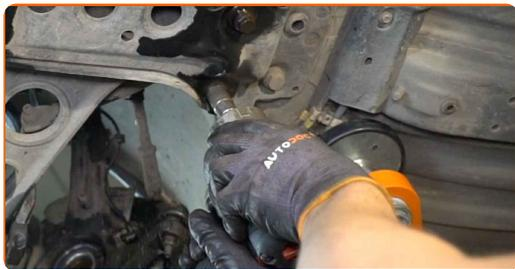
**23** Desaparafuse e remova os elementos de fixação da cobertura do arco da roda. Use a chave Phillips.
