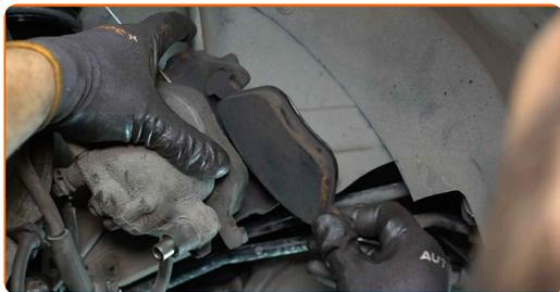
Substituição: pastilhas de travão – ALFA ROMEO GTV (916C\_). Conselho da AUTODOC:
