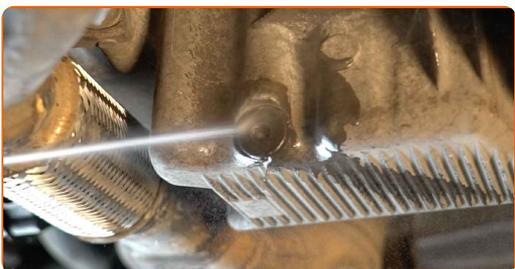
**7** Desaperte o bujão de drenagem. Use Torx T50. Use uma chave de catraca.
