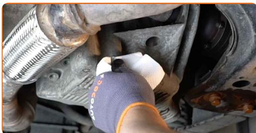
**17** Aparafuse o novo bujão de drenagem e aperte-o. Use Torx T50. Use uma chave de torque. Aperte-o para o torque de 20 Nm.
