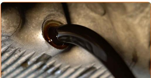
**Substituição: óleo do motor e filtro – ALFA ROMEO GTV (916C\_). Conselho:**
