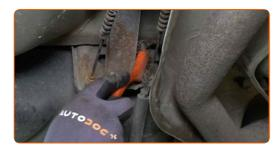
Remova o clipe de retenção do cabo do travão de estacionamento. Utilize um pé-de-cabra. Use um martelo.
