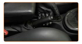
Desaperte o cabo do travão de estacionamento. Use uma chave combinada nº 13.
