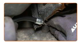
Prenda o cabo do travão de estacionamento com o clipe de retenção. Use alicates de bomba de água.
