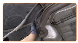
Limpe o fixador do cabo do travão de estacionamento. Use uma escova metálica. Use spray WD-40.
