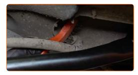
Desaparafuse o fixador do cabo do travão de mão. Use uma chave combinada nº 10.
