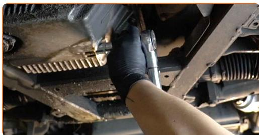
**19** Limpe a área do orifício de drenagem do cárter. Use o spray de limpeza universal.
