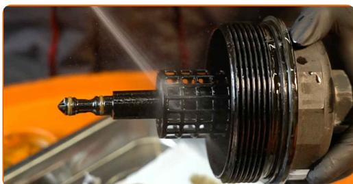
**15** Instale um novo anel O-ring no seu assento de montagem na tampa do filtro.
