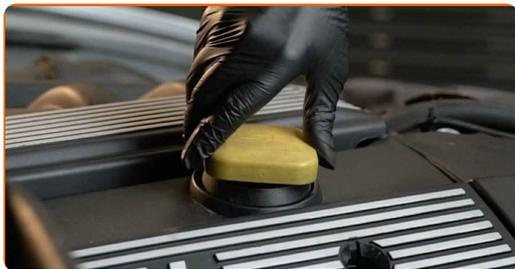
**29** Ligue o motor por alguns minutos. Após a luz de advertência da pressão do óleo se apagar, desligue o motor.
