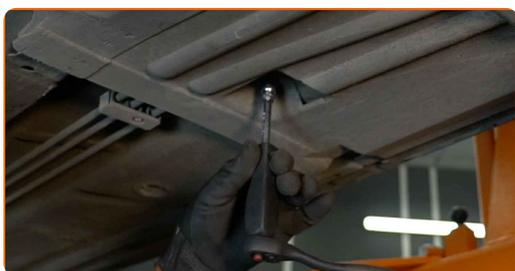
**7** Retire os cliques da parte inferior do painel de cobertura da carroçaria. Use uma ferramenta de remoção de clipe.
