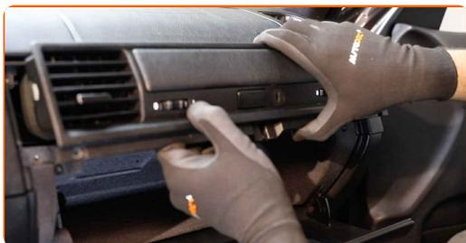
**5** Desaperte os parafusos de fixação do porta-luvas. Use a chave Phillips. Use uma chave de fenda plana.
