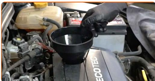
**28** Despeje o óleo no motor através do gargalo de enchimento de óleo. Quantidade necessária de óleo: 4.5 l.
