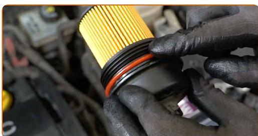
**25** Instale a nova tampa da caixa do filtro de óleo e aperte-a. Use uma chave soquete nº 24. Use uma chave de torque. Aperte-o para o torque de 25 Nm.
