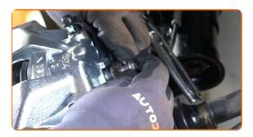
Aperte o elemento de fixação que liga o tubo de freio à pinça do travão. Use uma chave soquete nº 11. Use uma chave de torque. Aperte-o para o torque de 30 Nm.
