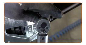
Limpe a sujidade do parafuso da mangueira do travão. Utilize um produto de limpeza para travões.
