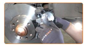
Aperte os fixadores da pinça do travão. Use HEX n.º H7. Use uma chave de torque. Aperte-o para o torque de 28 Nm.
