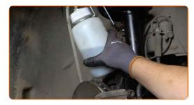
Aperte o parafuso de purga da pinça de travão. Use uma chave combinada nº 9. Use uma chave de torque. Aperte-o para o torque de 5 Nm.
