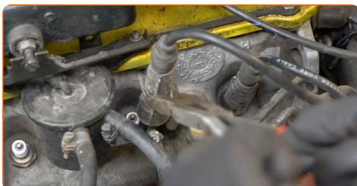
Substituição: vela de ignição – AUDI 100 C2 Avant (43). Conselho:
