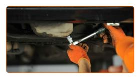
Limpe a área do orifício de drenagem do cárter. Use o spray de limpeza universal.
